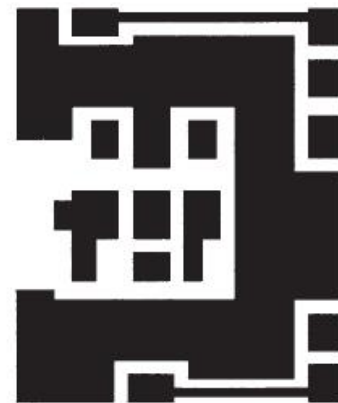
Gráfico 13 - Circuito impreso para la versión UHF.
